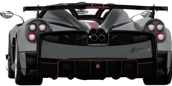
브레이크를 냉각하고 코너링 시에 공기 흐름을 유도하는 전면 플랩에서부터 거대한 리어 스포일러와 디퓨저까지, 충만한 공기역학적 설계로 완성됐다.
